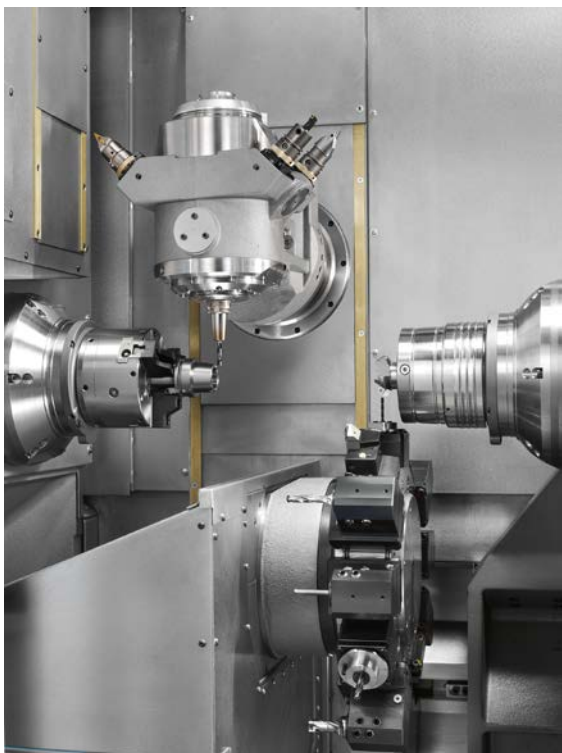
Bild 3: Werkzeugrevolver: Ist mit 18 oder 12 Stationen verfügbar und besitzt eine Y-Achse mit einem Verfahrbereich von +/- 50 mm.
