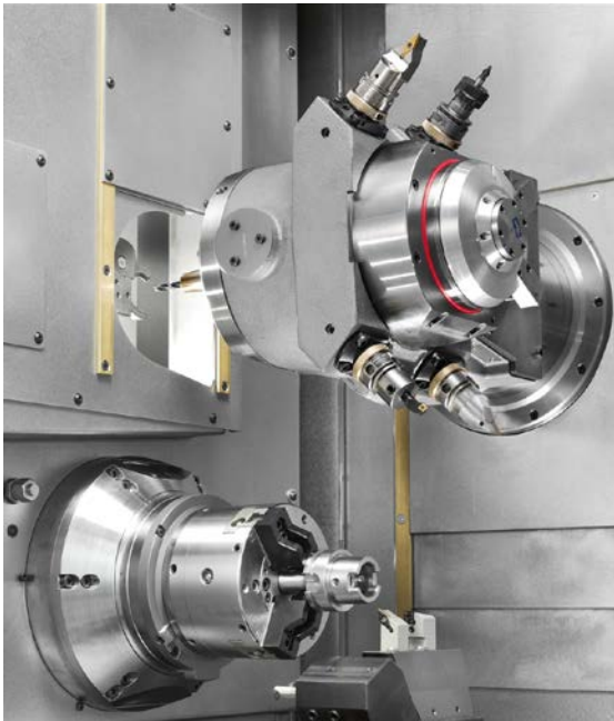
Bild 2: Motorfrässpindel: Sie eignet sich auch für komplexe fünfachsig Fräsarbeiten
